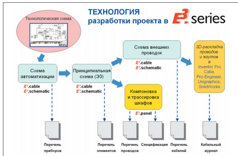
Рис. 1. Технологическая цепочка проектирования в среде E 3 .series 2006
