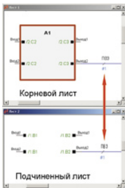
Рис. 10. Демонстрация сквозного проектирования в E 3 .series
